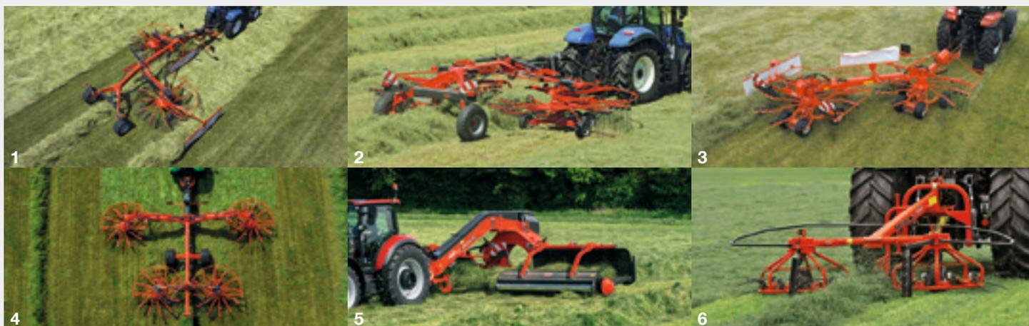
1. Giro-andaineurs double rotors semi-portés à dépose latérale - 2. Giro-andaineurs double rotors semi-portés à dépose centrale - 3. Giro-andaineurs double rotors traînés - 4. Giro-andaineurs à 4 rotors - 5. Andaineurs à tapis - 6. Faneurs andaineurs
