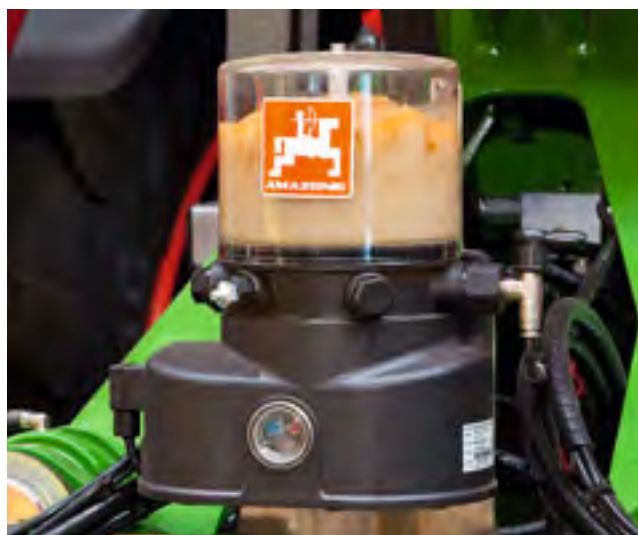
Pompe avec réservoir de stockage
