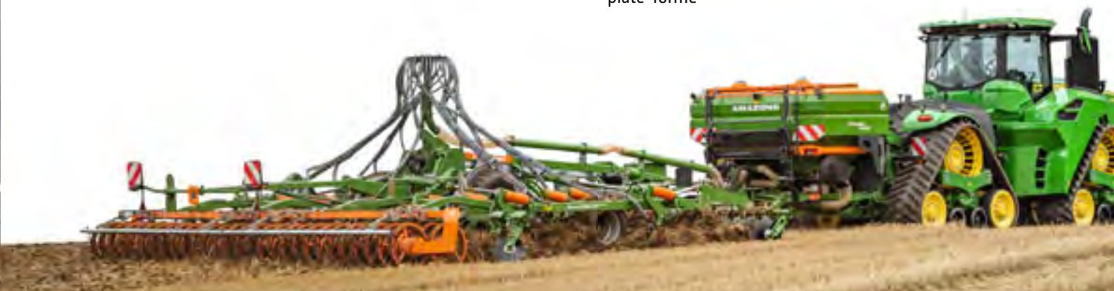
Trémie portée XTender 4200, capacité de 4 200 l avec Ceus 7000-2TX
