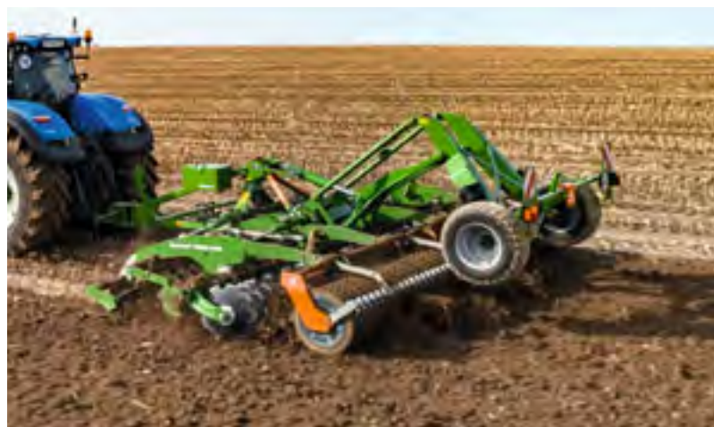
Catros XL 6003-2TS avec rouleau hacheur en amont
