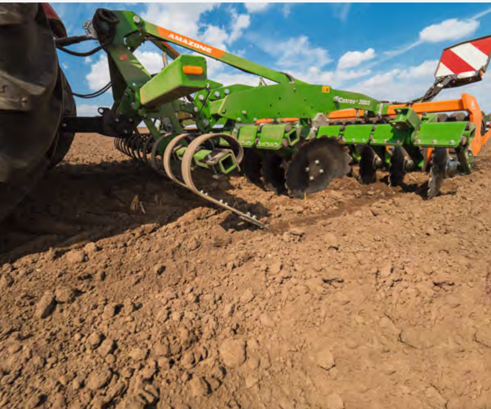
Catros+ 3003 avec Crushboard au travail
